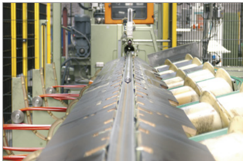
Die Stangen werden linear transportiert, ohne dabei in Rotation versetzt zu werden. Das Prüfsystem arbeitet statisch ohne Rotation.
