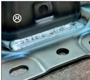
Schweißnaht mit Silikat- ausscheidungen und schlechter Nahtzeichnung
