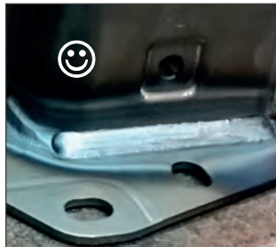
Schweißnaht mit PLATINARC geschweißt
